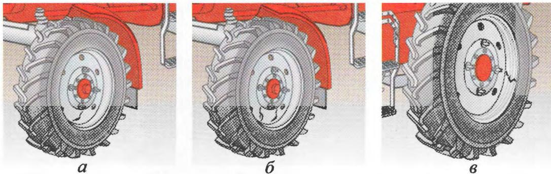
1. Имеется одна трещина диска колеса (а).
