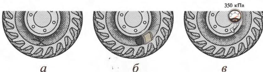
1. Шина переднего колеса имеет несквозной разрыв, корд не обнажен (а).
