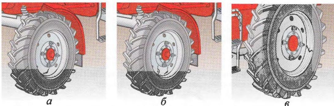
1. Имеется одна трещина диска колеса (*a*).
